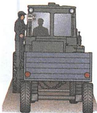
1. Разрешается при переезде на расстояние не более чем на 100 м.
