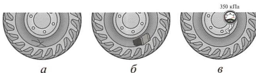
1. Шина переднего колеса имеет несквозной разрыв, корд не обнажен (а).
