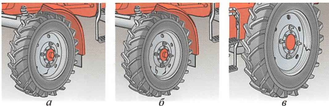
1. Имеется одна трещина диска колеса (а).
